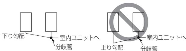
分岐管キットを熱源ユニットベースより高い位置で設置する場合は、分岐管キット取付高さを熱源ユニットベースから200mm以下としてください。
