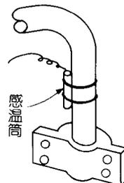
交換時、膨張弁出口のフレアナットにはロックタイト225を塗布してください。ロックタイトを塗らないとフレアナットが抜ける場合があります。膨張弁の感温筒は必ず元の位置(高段吸入フランジ手前の垂直配管部)に取付けてください。
