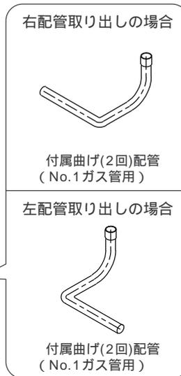
左配管取出し時のNo.1ガス管は、前面からの後ろフィルター脱着時に手が触れるおそれがあるため、本体内直管部の奥までパイプカバーを巻いてください。
