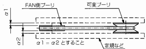
(図2) 可変プーリ使用時の平行度の調節
