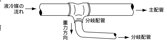
液配管の分岐
