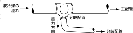
液配管の分岐
