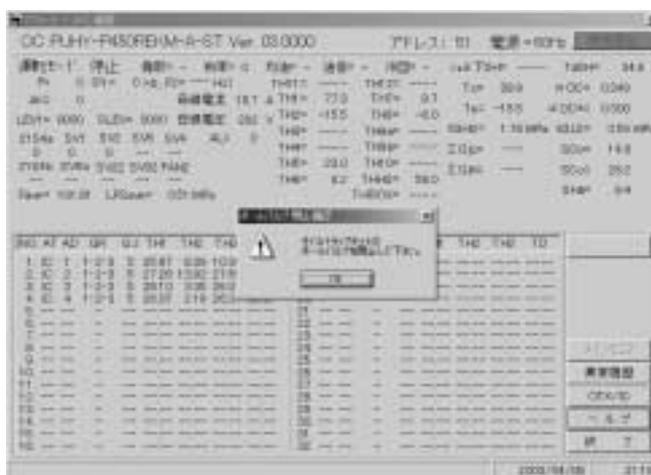
電磁弁が数秒間開いた後、左記の画面表示が表示されるのでオイルトラップキットのボールバルブを閉じて、[OK]をクリックしてください。
