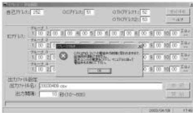
電磁弁作動音確認にて、[いいえ]をクリックすると2回電磁弁の開閉を行い、3回連続して[いいえ]の場合、左記の表示となりますのでOTK内の電磁弁の点検を行ってください。
