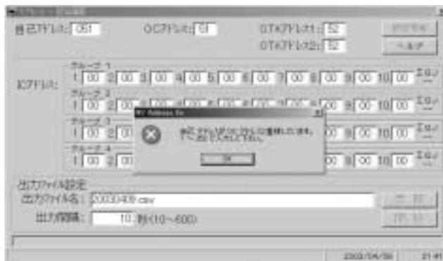
異常検知時の表示例(高圧圧力異常検知:[異常コード1302])
