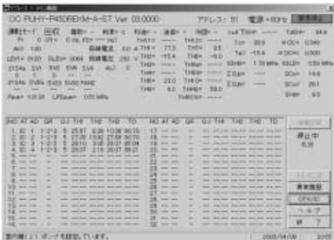
冷媒回収中において、低圧（63LS）の値が0.11MPa以下になった場合には、圧縮機が停止し「停止中」と表示します。
