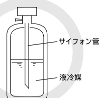
【サイフォン管付ポンベの場合(立てたまま液冷媒を充てんできる)】
