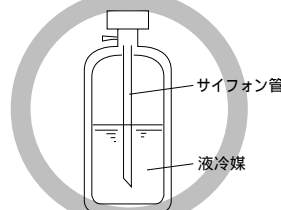
【サイフォン管付きポンペの場合(立てたまま液冷媒を充填できる)】
