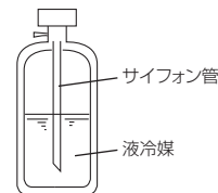
【サイフォン管付ポンベの場合(立てたまま冷媒を充てんできる)】
