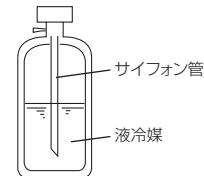
【サイフォン管付ポンベの場合(立てたまま冷媒を充てんできる)】
