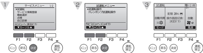
【手順3】試運転操作を行い吹出し温度、オートペーンなどの機能に応じて確認をします。
