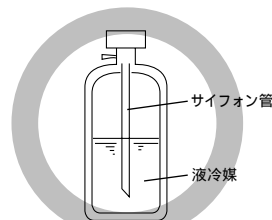
【サイフォン管付きポンベの場合(立てたまま液冷媒を充てんできる)】
