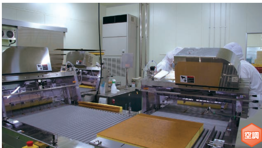
面積の広い製造ラインの空調には、必要な箇所にのみ吹出しダクトを配置
