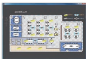
〈空調照明運転モニタ〉
