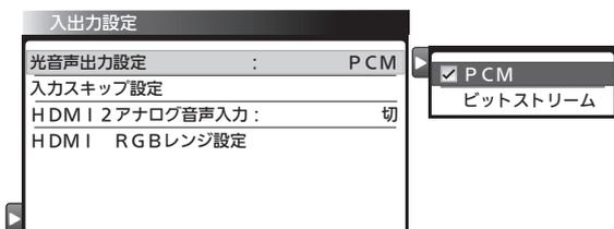
「PCM」……………ビットストリームに対応していないオーディオ機器を接続の場合に設定します。
