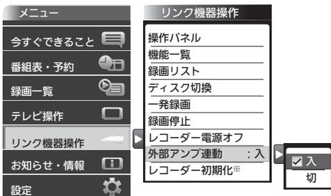
「入」で本機は消音され、AVアンプの電源が「入」になり、本機のリモコンで音量を調節できるようになります。
