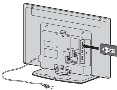
本体後面から見てB-CASカードの矢印の絵柄が見えるようにして、カード絵柄の矢印の方向に挿入します。
