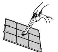
プレフィルターの汚れがひどいときは、中性洗剤で洗ったあと水洗いし、陰干しで充分乾燥させる
