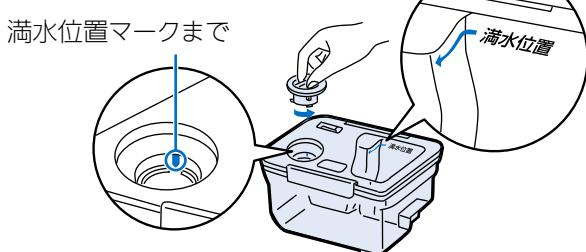
**4** 給水栓をしめ、給水タンクを水平に持ちながら、元に戻す
