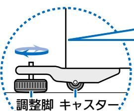
調整脚を矢印の方向に回し、下げる
