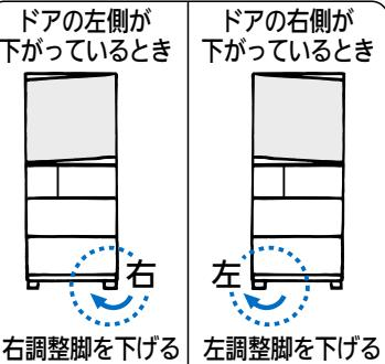
設置場所が水平でなかったり、据付けから数日後食品の重みで脚が沈んだりすると、ドアが下がってみえます。
