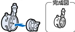
**4** キャップのツメ部(C)を給水ポンプの凸部(D)に回転してかける
