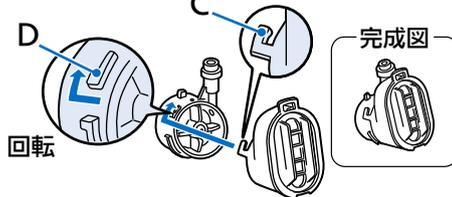
**5** 給水ポンプを給水タンクに回転して取り付ける(確実に)
