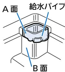
4 タンクパイプと給水パイプ接合部に異物がないか確認する
