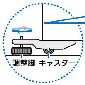
調整脚を矢印の方向に回し、下げて床につける
