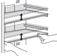
お手入れのときは冷蔵庫の棚(強化ガラスシェルフ)の取付け、取りはずしは確実にする
