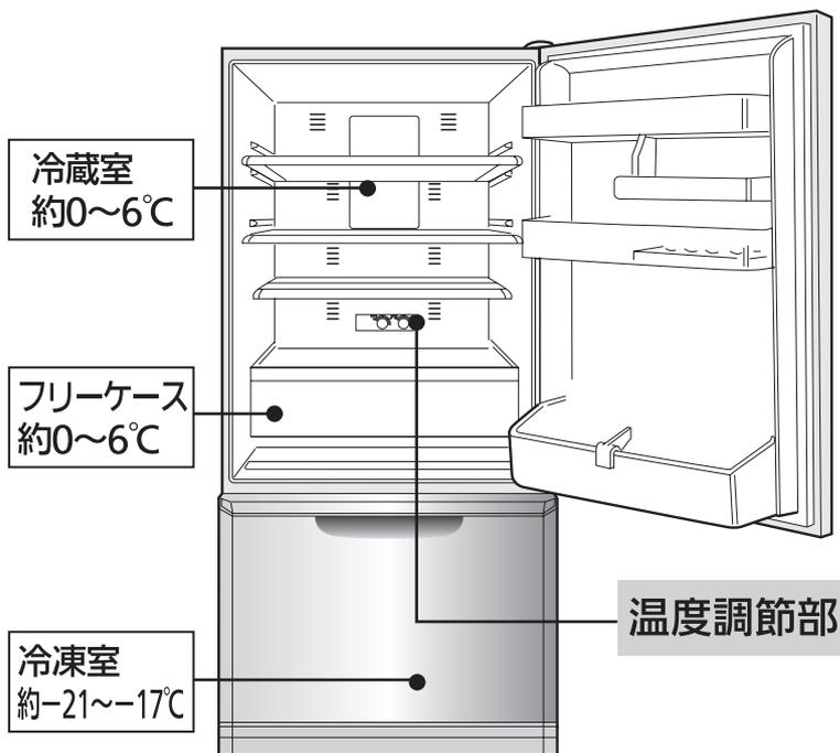
※表示温度は冷蔵室、冷凍室の温度調節を「中」の位置に合わせ、周囲温度30℃、食品を入れずにドアを閉め、温度が安定したときに、庫内のほぼ中央下寄りで測定した温度の目安です。
