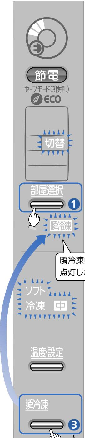
1 部屋選択 1 を押し、切替を点灯させる
