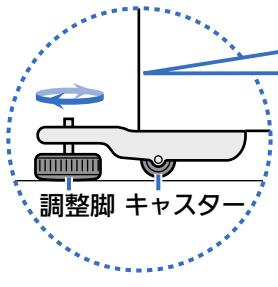
調整脚を矢印の方向に回し、下げる
