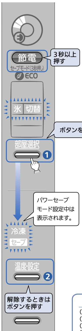
操作パネルの表示を点灯させる（**部屋選択** ① を押す）
