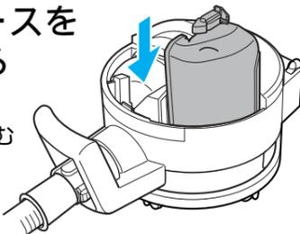
ダストケースをしっかり取りつけないと、「ピッピッピ」と約5秒間音がしてパワーレベルランプが早点滅します。
