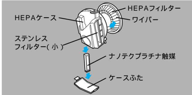
お掃除ごとにHEPAフィルターお掃除メカ P2 を動作させることにより、当社試験条件でHEPAフィルターのお手入れ回数は軽減され、吸込力が持続します。
