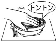
HEPAフィルターを時計回りに回し、ワイパーを印に合わせる
