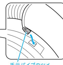
本体の取り付け穴に、伸縮パイプのストッパーを差し込む
