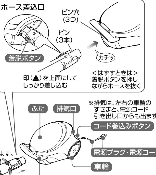
※排気は、左右の車輪のすきまと、電源コード引き出し口からも出ます。
