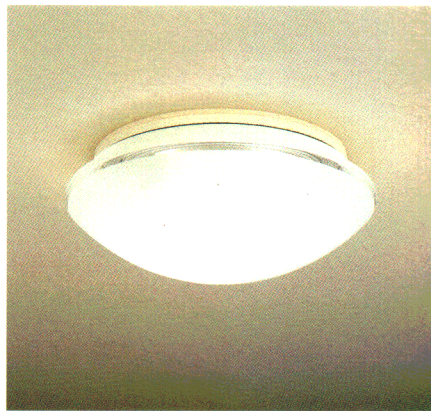
WC1290T (防雨・防湿) ○¥15,800 ① 40W電球(ミニランプ)(E17)×2 透明部分消しガラスグローブ 白色塗装本体 幅φ310 高さ108 ●天井付専用
