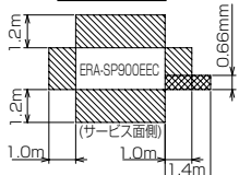
据付スペース
