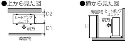
所要スペース(D1及びD2)は、障害物の高さ(H)によってかわります。風向ガイドを取り付ける場合は、下表を参照ください。ただし、設置条件によっては運転音が上がることがあります。
