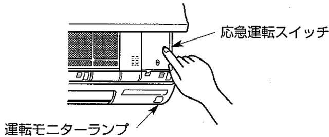
室内機の運転モニターランプ (2個) を用いて運転内容を表示します。
