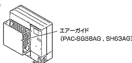
台風等の強風が吹出口に吹付けるような据付場所には別売エアーガイドを取付けてください。
