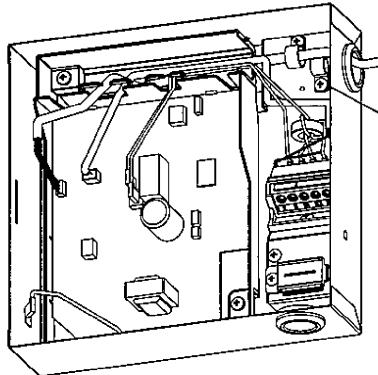
③外したクランプでレシーバー延長コード(MAC-005RC-SK)を固定し、コネクターを室内制御基板(LD101(A))へ差込みます。
