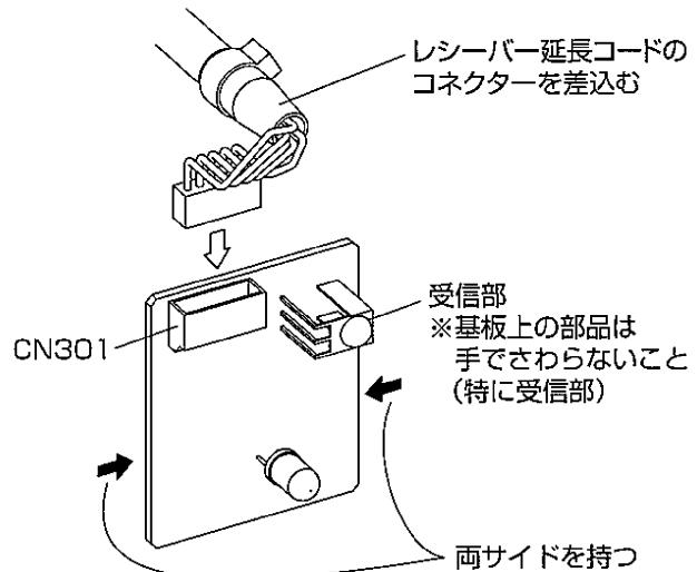
⑦受信基板を受信装置カバーに取付けます。
