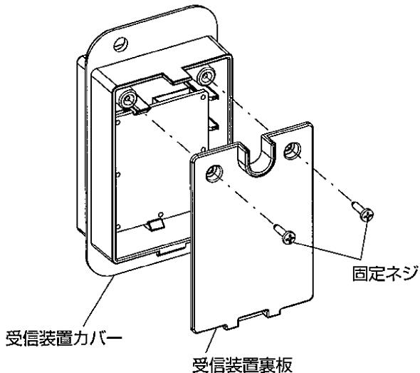
⑥受信基板を受信装置カバーから外し、レシーバー延長コードのコネクターを差込みます。
