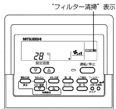
※ フィルター清掃後 [フィルター] ボタンを2度押すと表示が消えリセットされます。
