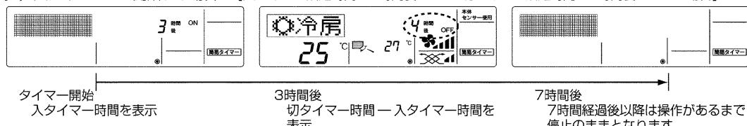
例2) 切タイマーから開始する場合 【入タイマー設定時間：5時間後ON 切タイマー設定時間：2時間後OFF の場合】
