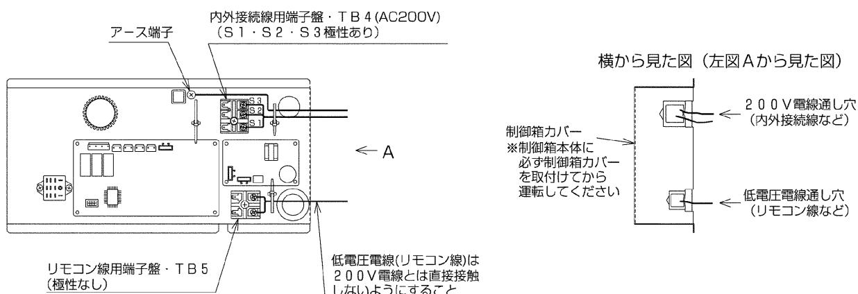
■電源配線は、分岐開閉器、室内、室外の配線パターンとして下記の方法があります。
