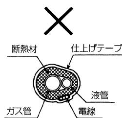
※液管とガス管を同時に断熱しないこと
