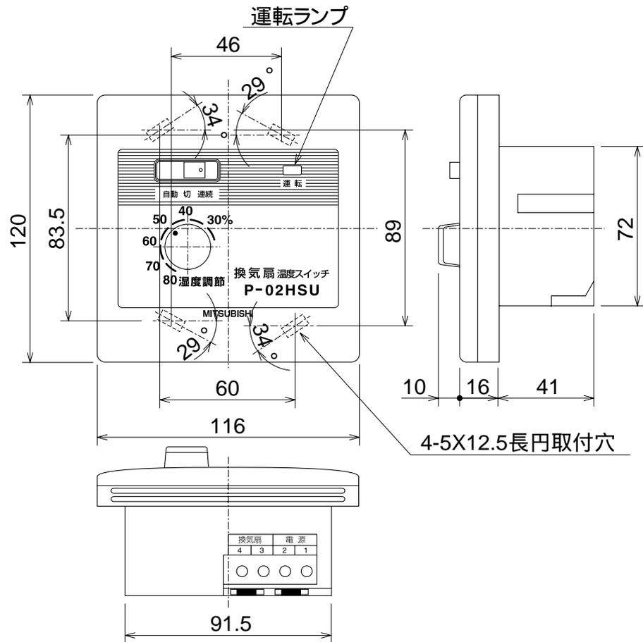
取付けはJIS C 8336の「中形四角アウトレットボックス深形」または「中形四角コンクリートボックス」を使用して壁面に取付けてください。また、壁仕上げ面よりスイッチボックス底面60mm以上確保できれば「2個用スイッチボックス(カバーなし)深形」も使用できます。
