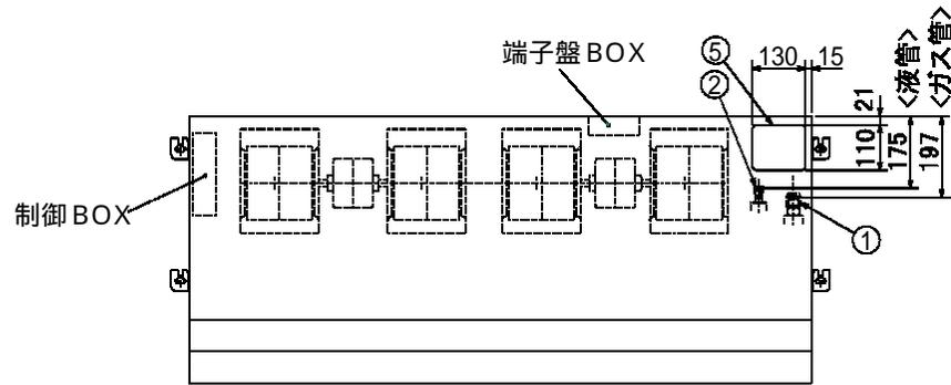
冷媒配管接続口 (ガス側/フレア接続 : 3/4 F)
