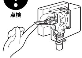
点検しないとタンクや配管が破損したり、逃し弁から水漏れしたりすることがあります。
