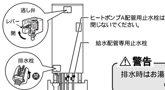
ヒートポンプA配管用止水栓は閉じないでください。
