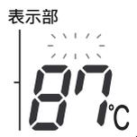
「給湯温度」が消え、給湯機の温度表示になります。約10秒間表示後、給湯温度を表示します。
