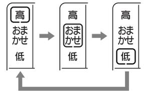
押すごとに、タンクのわき上げ温度設定表示が切り換わります。
