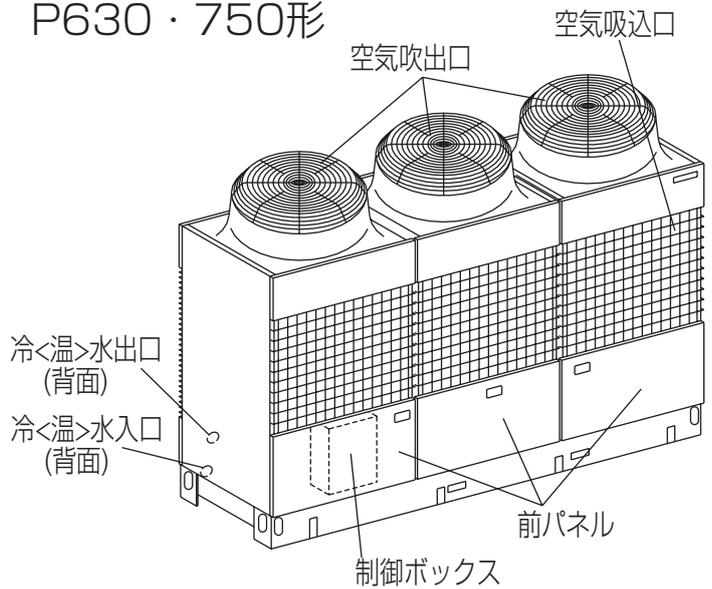
注. 冷水>温水入口および冷水>温水出口は左面取出または、背面取出のいずれか選択となります。
