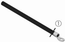
ユニット側電線としてご使用ください。<br>CA(H)V-P***VA(2) 形に適用した圧着端子 (M8 用) を取付けています。<br>CA(H)V-MP***VB 形に使用する場合は①部で切断し、No.21 の圧着端子 (M10 用) と No.22 の絶縁キャップを再取付けしてください。 | R-S-T<br>各相 3m<br>2 本ずつ<br>(赤白青) |
