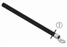
ユニット側電線としてご使用ください。<br>CA(H)V-P***VA(2) 形に適用した圧着端子 (M8 用) を取付けています。<br>CA(H)V-MP***VB 形に使用する場合は①部で切断し、No.21 の圧着端子 (M10 用) と No.22 の絶縁キャップを再取付けしてください。 | R-S-T<br>各相 3m<br>3 本ずつ<br>(赤白青) |
