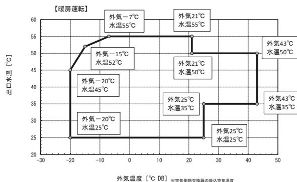
※ 上記運転範囲を逸脱した場合、ユニット保護制御により能力セーブ運転、あるいはユニットが停止することにより、目標とする水温を供給できません。
