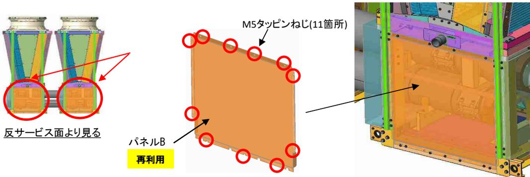
(3) 連結配管側にパネルを取り付けてください。
