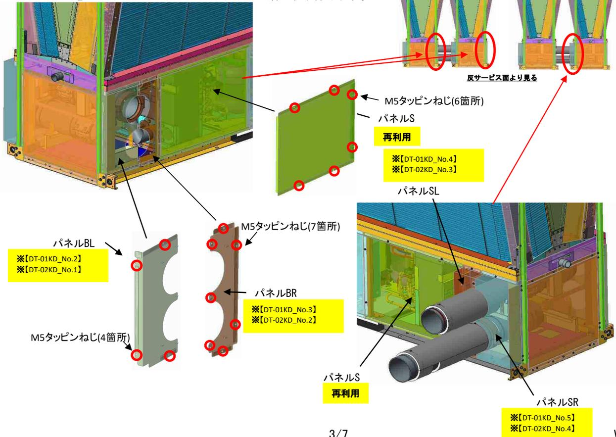
DT-R ヘッダー内蔵仕様 連結配管取り付け要領(右配管の場合)
