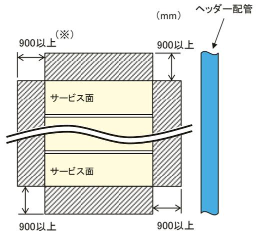
※: CA(H)V-MP2000(V)B(E)形、CAHV-MP1800(V)B(E)H形、CAV-MP2360(V)B(E)形、CAV-MP1800(V)B(E)C形は、1200mm以上
