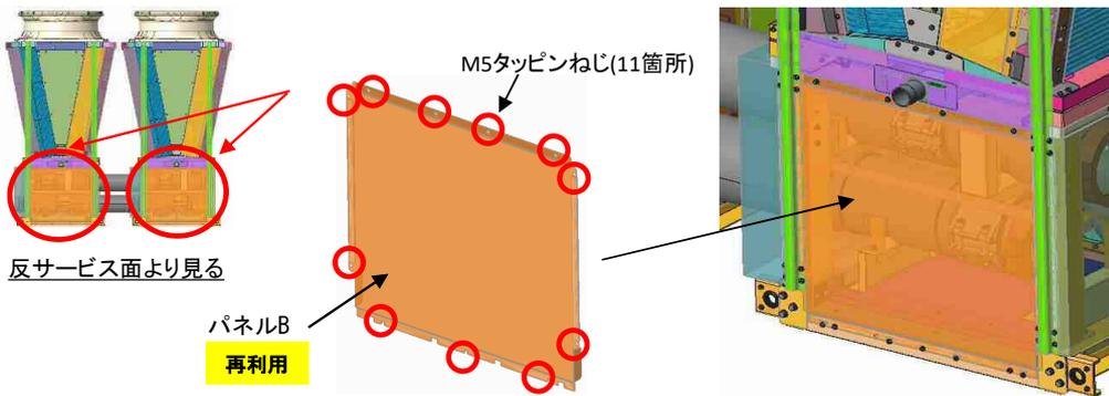
(3) 連結配管側にパネルを取り付けてください。
