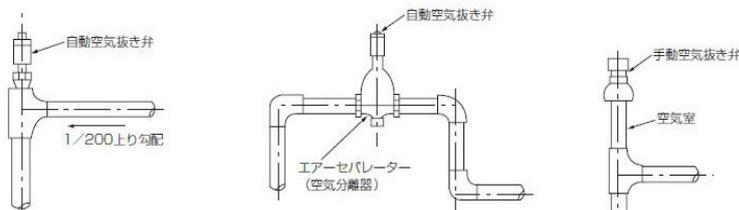
配管中に空気だまりができないように、膨張タンクまたは空気抜き弁に向かって1/200以上の上り勾配をつけると共に、空気がたまる可能性がある部分には必ず自動空気抜き弁または手動の空気抜き弁を設けてください。
