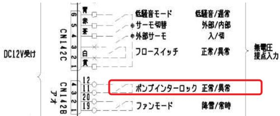
※複数台ユニット運用時には、必ず全ユニットのポンプインターロック回路(ユニット端子台:⑪-⑫間)にポンプインターロック回路配線を接続してください。
