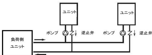
(6)給湯用途の場合で、複数台ユニット運用時の水配管方式
