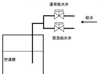
※給水弁一次側の水圧は、選定した給水弁の仕様に合わせてください。
