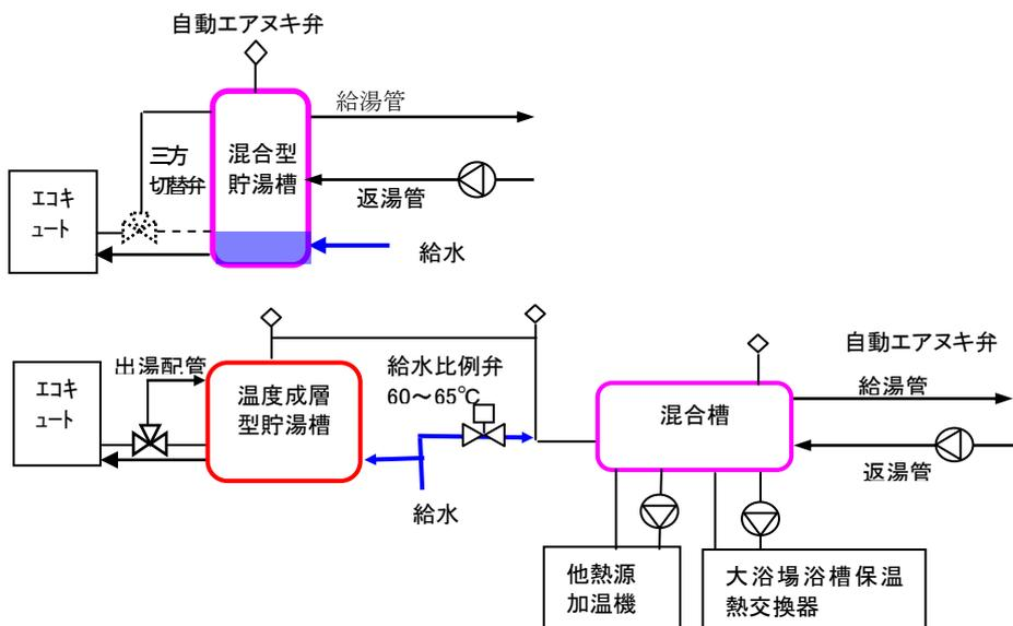
三方切替弁は貯湯運転中以外は停止中も含め貯湯槽下方側に繋がるようにします。停止中の自然凍結防止運転および貯湯運転後のポンプ残留運転は貯湯槽下方との間で循環し、温度成層が崩れることを回避します。
