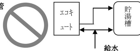
エコキュート入口配管に接続すると運転中の入水温度急変(瞬時 $5\text{K}/\text{min}$ 以上あるいは連続 $1\text{K}/\text{min}$ 以上)により異常停止(高圧、ガスクーラ出口温度)や出湯温度低下を生じます。
