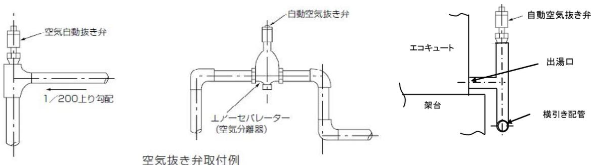
空気抜き弁取付例
