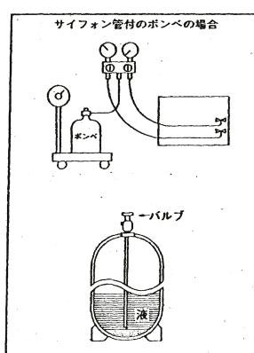
図13-3. ボンベの種類と冷媒チャージ方法
