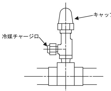
図13-1. 冷媒チャージ弁
