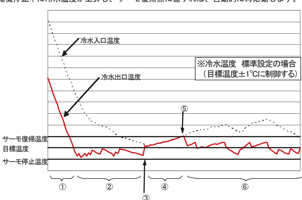
図 5-2 冷水出口温度制御
