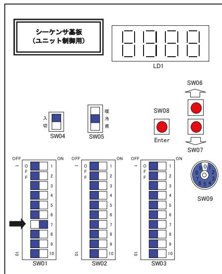
図5-4 高精度設定時のDIPスイッチ設定
