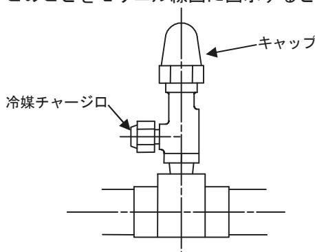
図 13-1. 冷媒チャージ弁
