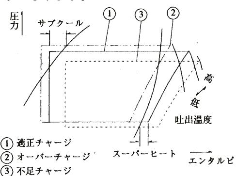
図 13-2. 冷媒チャージ量とモリエル線図
