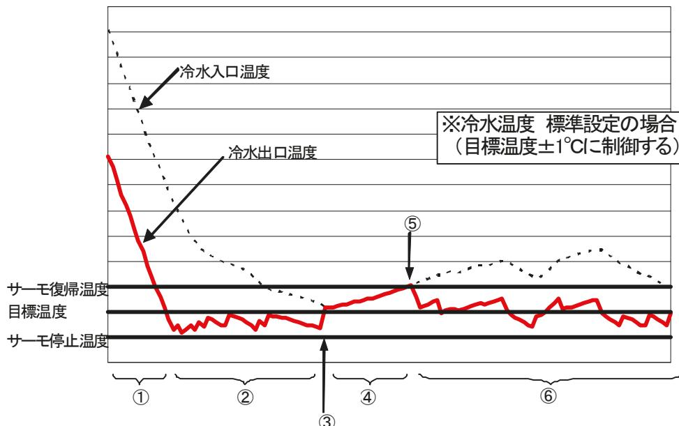
図 5-2 冷水出口温度制御
