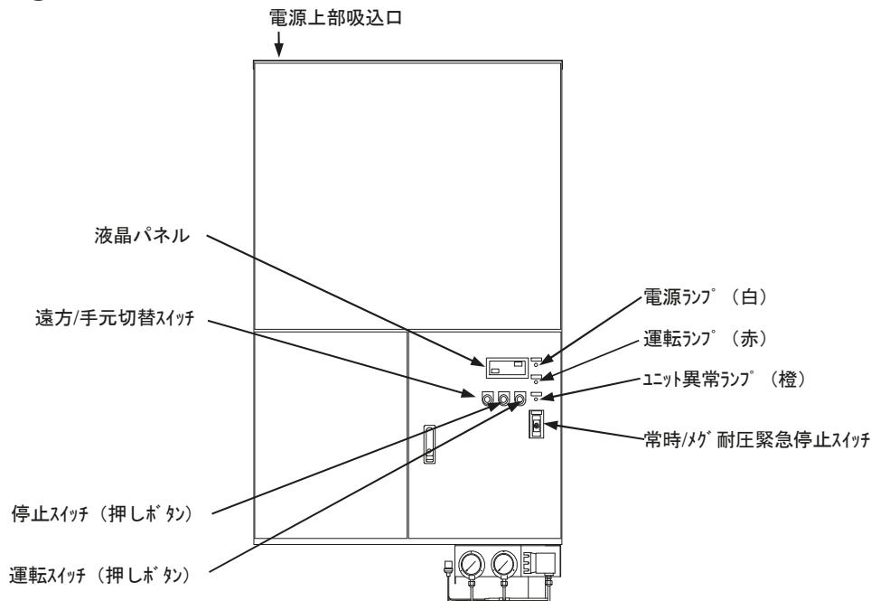
図 3-4. 制御箱外観（サービス面）
