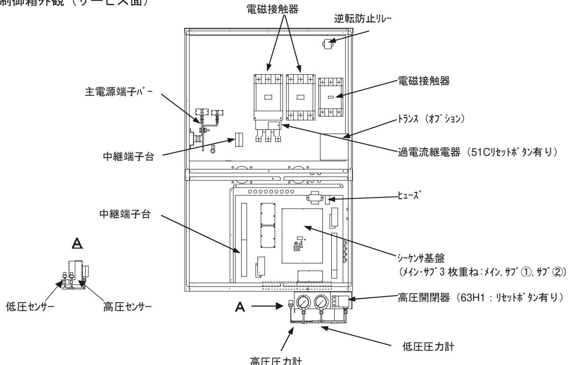
図 3-5. 制御箱内部（サービス面）
