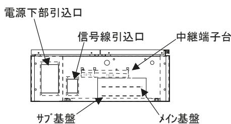
図 3-3. 制御箱内部（底面）
