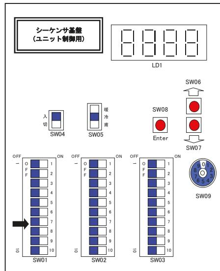
図5-3 標準設定時のDIPスイッチ設定
