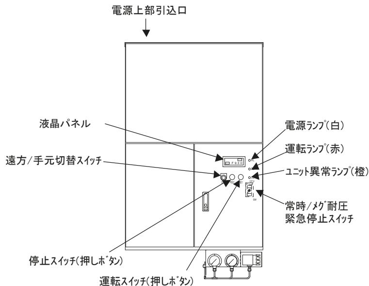
図 3-1. 制御箱外観（サービス面）
