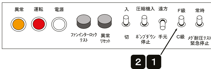
制御箱操作ボード上の切替スイッチ
