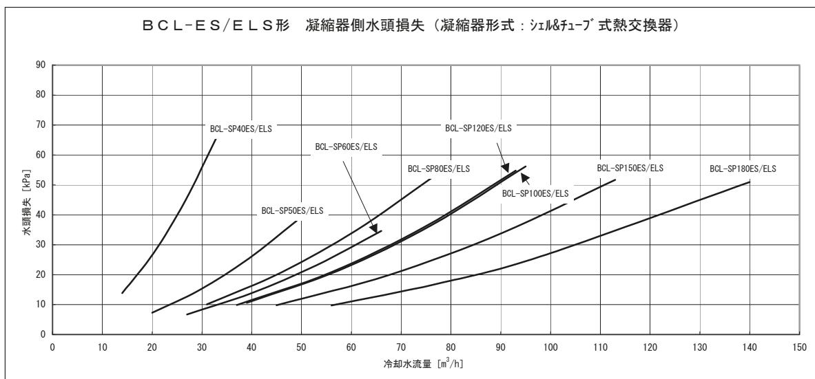
図 3-1 凝縮器側水頭損失
