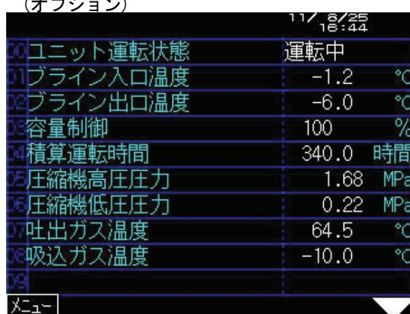
図 4-1 運転モニター(標準)
