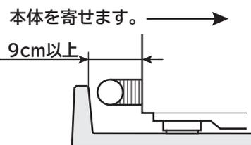
●四隅が高くなっている防水パンは、排水ホース出口位置が高くなります。(a)寸法が19mm以下の防水パンに設置できます。
