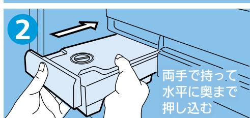
タンクキャップを閉じて給水タンクを元に戻す
