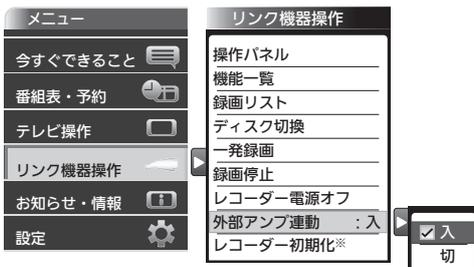
「入」で本機は消音され、AVアンプの電源が「入」になり、本機のリモコンで音量を調節できるようになります。
