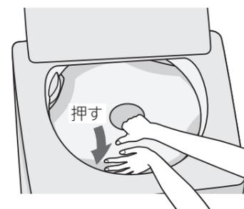
**2** 中央リング部を図のように持ち、矢印の方向に曲げる
