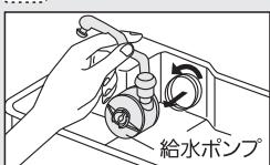
3 パイプを引き抜き、キャップを回してはずし、ハネを取り出し水洗い
