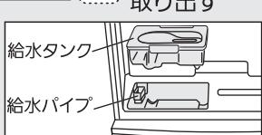
2 給水パイプを引き抜き流水で水洗い
