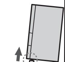
※設置から数日後、重みで床が沈むことがあります。調整脚で傾きを再調整してください。
