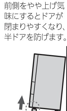
※設置から数日後、重みで床が沈むことがあります。調整脚で傾きを再調整してください。
